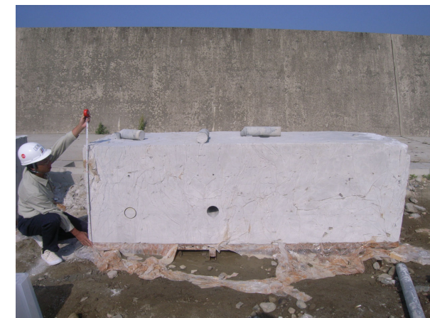
3. 脱枠後の試験体
