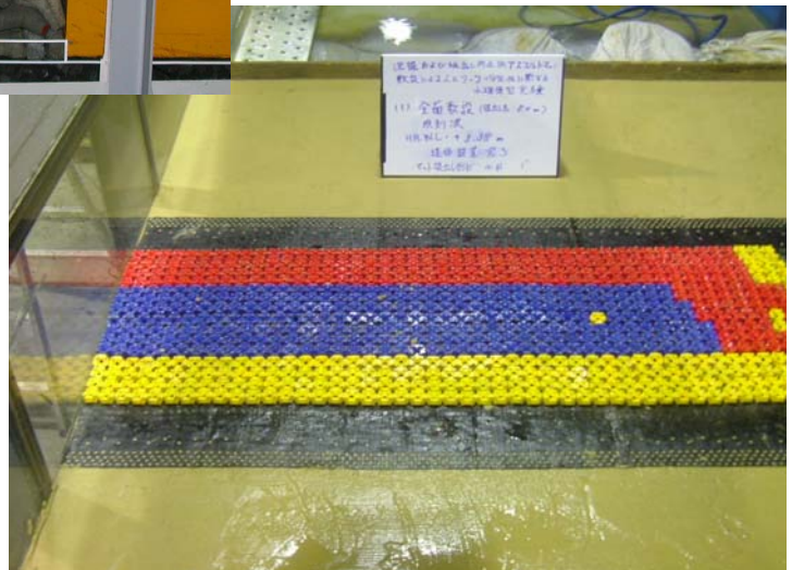
アスファルトマットの安定性水理模型実験
