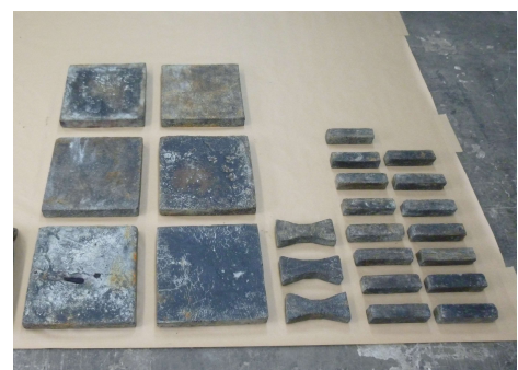
写真-4 取り出した供試体
