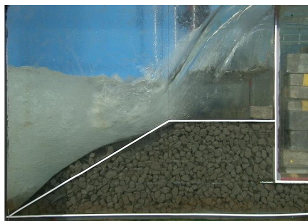
図-6 腹付工法面の捨石の一部崩れの様子(case15)
