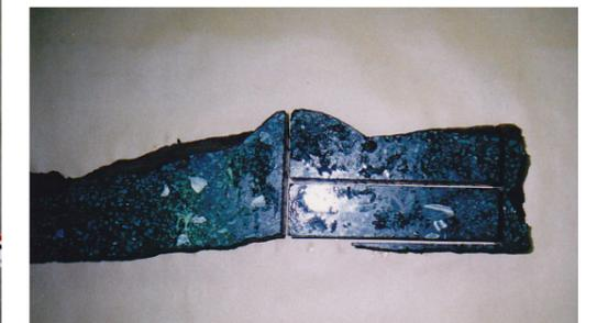
写真-3 試験体の切出し (4×4×16 cm)
