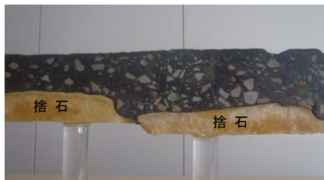
捨石間隙への KAM の食い込み状況(現地採取試料)
