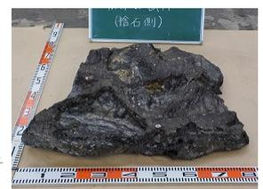
図1 防波堤断面図(和歌山下津港) 図2 As マット塊(和歌山下津港)
